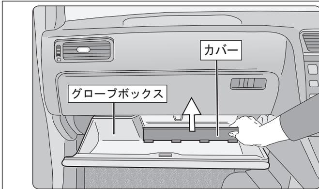
グローブボックスを開いた状態のままにして、ボックス奥に取り付いているカバーを手前に引いて取り外します。
