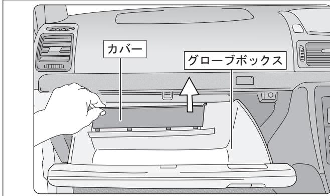
グローブボックスを開いた状態のままにして、ボックス奥に取り付いているカバーを取り外します。
