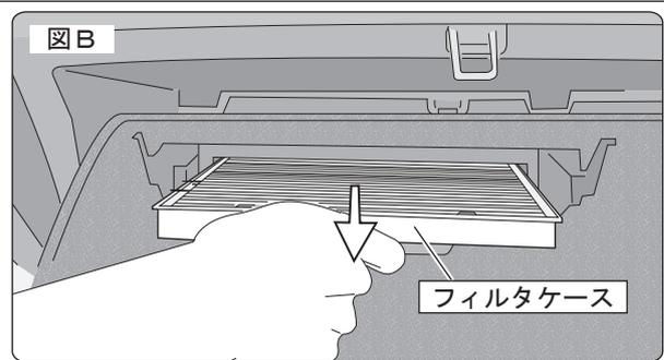
フィルタカバーに付いているツマミ(左右各1箇所)を持って手前に引いてカバーを取り外します。(図A) カバーを取り外したら、中に装着されているフィルタケースを手前に引き出します。(図B)
