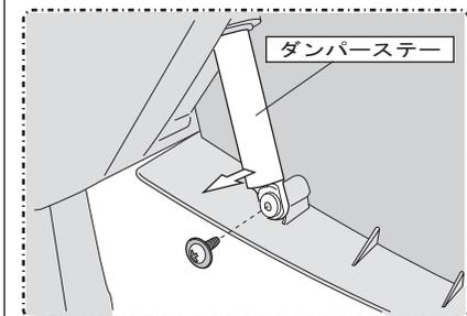
グローブボックスを取り外す前に、ダンパーステーに付いているネジ(お車によってはネジが付いていないものもあります)を外し、ダンパーステーをグローブボックスから外しておくとグローブボックスの取り外しがより楽になります。
