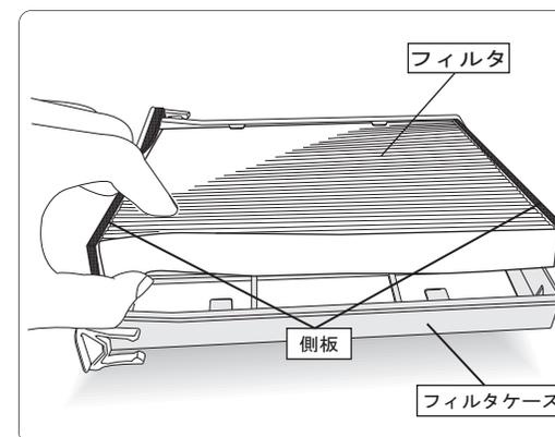
フィルタケースから汚れたフィルタを取り外し、新しいフィルタを取り付けます。フィルタの側板が手前・奥に来るようにセットしてください。
