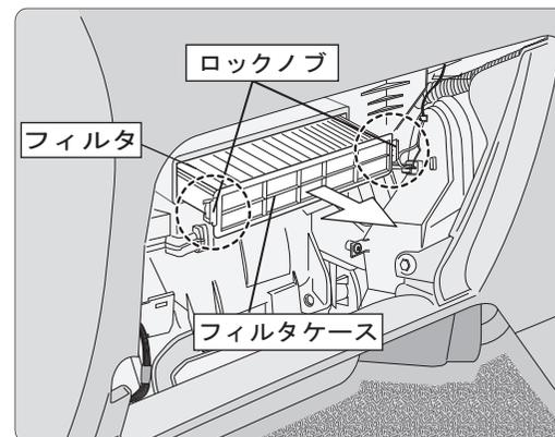
フィルタケースの両端に付いているロックノブを解除し、手前にフィルタケースを引き出します。
