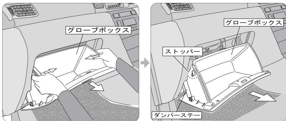
グローブボックスを開き、ボックス側面を左図のように内側に押しながら、ボックスに付いているストッパーを片側ずつ解除した後、グローブボックスを手前に引いて取り外します。
