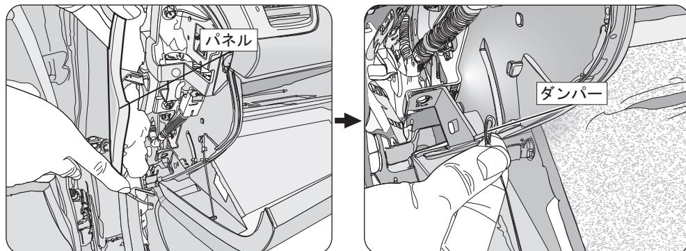
グローブボックスを開いて左側のパネルを取り外し(左図)、ダンパーを取り外します。(右図)
