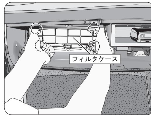
フィルタケースに付いているロックノブ(上下各2箇所)を解除して手前に引き、フィルタケースを取り外します。
