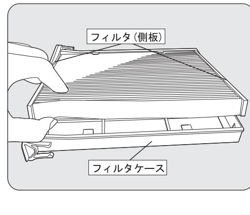
汚れたフィルタを取り出し、新しいフィルタと交換します。
