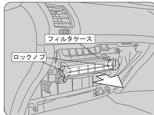
グローブボックスを取り外すとフィルタケースが見えてきますので、左右のロックノブを解除して手前に引いて取り外します。
