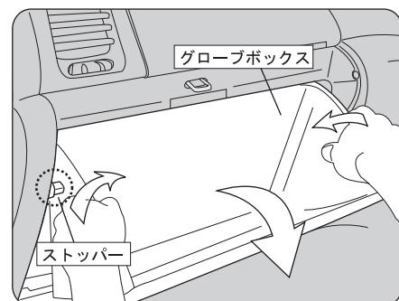
グローブボックスを開いてから、グローブボックス側面を矢印方向に押しながら手前に引いて、グローブボックス左右奥に付いているストッパーを開放して、グローブボックスを外してください。
