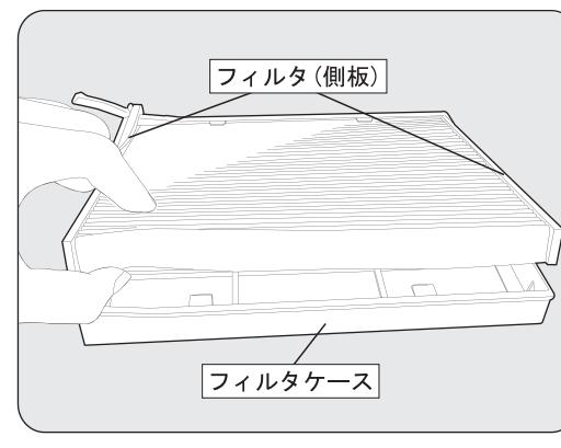
汚れたフィルタを取り出し、新しいフィルタと交換します。
