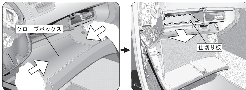
グローブボックスの両サイドを内側に押して、手前に引きグローブボックスのストップバーを開放するとグローブボックス全体を開放することができます。グローブボックスを開放したら、右図点線部分の仕切り板全体を手前に引いて取り外します。
