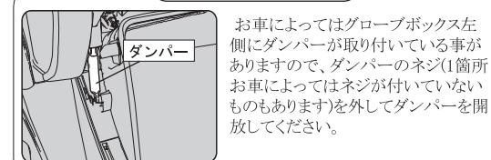
お車によってはグローブボックス左側にダンパーが取り付いている事がありますので、ダンパーのネジ(1箇所)お車によってはネジが付いていないものもあります)を外してダンパーを開放してください。
