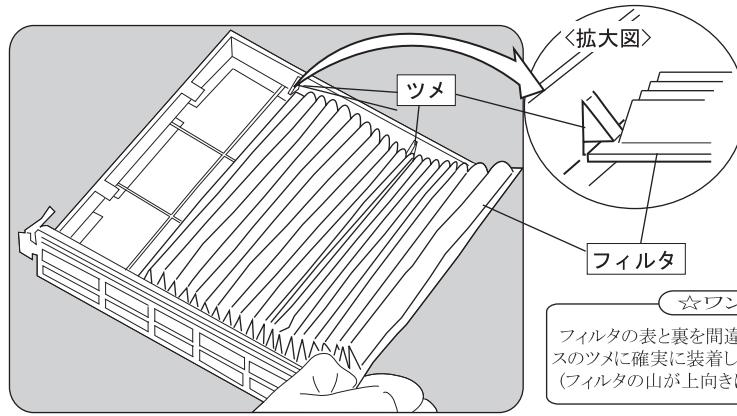
汚れたフィルタを取り外し、新しいフィルタと交換します。
