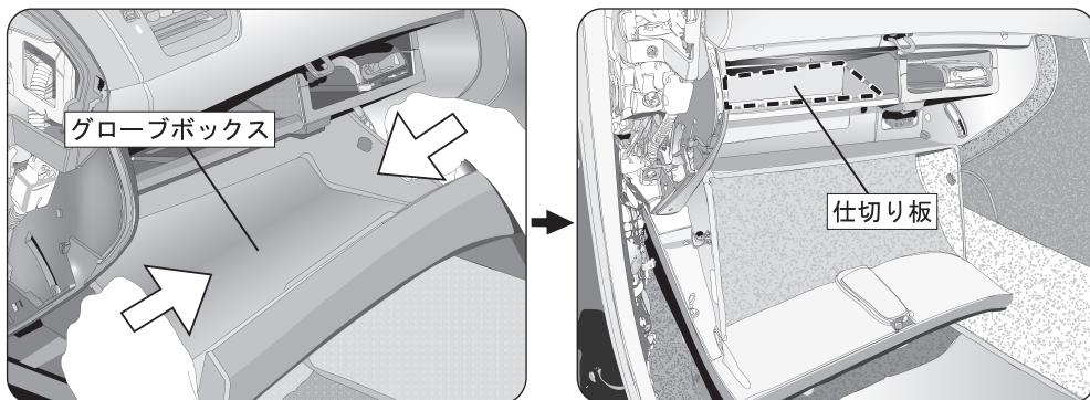
グローブボックスの両サイドを内側に押して、手前に引きグローブボックスのストップバーを開放するとグローブボックス全体を開放することが出来ます。グローブボックスを開放したら、右図点線部分の仕切り板全体を手前に引いて取り外します。
