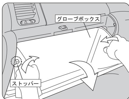
グローブボックスを開いてから、グローブボックス側面を矢印方向に押しながら手前に引いて、グローブボックス左右奥に付いているストッパーを開放して、グローブボックスを外してください。
