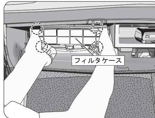
フィルタケースに付いているロックノブ(上下各2箇所)を解除して手前に引き、フィルタケースを取り外します。
