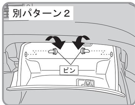
お車によってはグローブボックスの下部や左右内側に付いているピンを抜いてグローブボックスを外すタイプのものがあります。グローブボックスの両サイドを押してもストッパーが開放出来ない時等、グローブボックスにピンが付いていないか確認してください。
