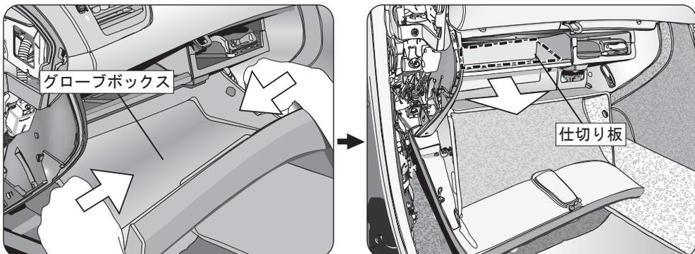
グローブボックスの両サイドを内側に押し、手前に引きグローブボックスのストッパーを開放するとグローブボックス全体を開放することが出来ます。グローブボックスを開放したら、右図点線部分の仕切り板全体を手前に引いて取り外します。
