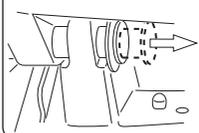
ピンを外す際は、内側ピンを外してから引き抜きます。(別パターン1の車種)
