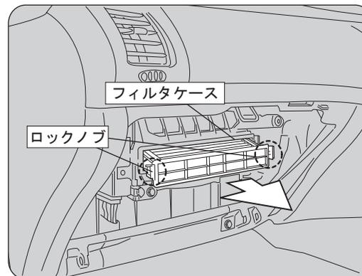
グローブボックスを取り外すとフィルタケースが見えてきますので、左右のロックノブを解除して手前に引いて取り外します。
