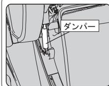
お車によってはグローブボックス左側にダンパーが取り付けられている事がありますので、ダンパーのネジ(1箇所)お車によってはネジが付いていないものもあります)を外してダンパーを開放してください。
