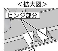
グローブボックス下部は左図のように突起状のヒンジ部分が左右に付いていてパネルに引っかかる仕組みになっています。
