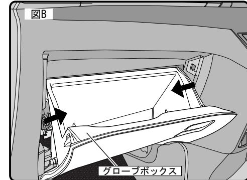
グローブボックスの両サイドを内側に押してグローブボックス左右奥(各1箇所)に付いているストップバーを解除する方法(図B)と、左右片側ずつ手前方向に引いて、グローブボックス下部に取り付いているヒンジ部分を引き抜く方法(図C)と2通りあります。図Bの方法で上手く行かない時は図Cの方法を試してみてください。
