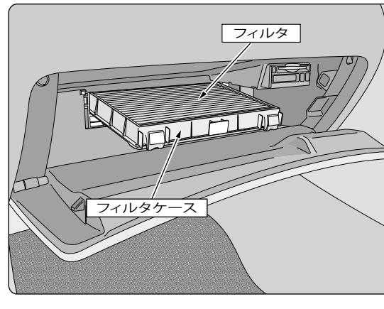
フィルタケースから汚れたフィルタを取り外し、新しいフィルタを取り付けます。
