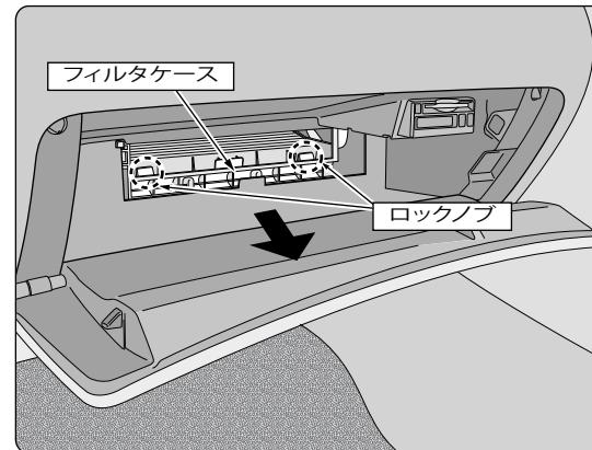
フィルタケースの両側に付いているロックノブを解除し、フィルタケースを手前に引き出します。
