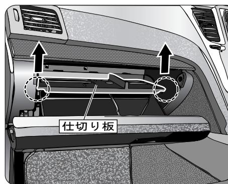
仕切り板の結合部分(左右各1箇所)を片側ずつ上に上げて取り外します。
