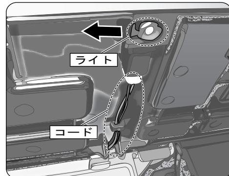
グローブボックス上部に付いている仕切り板のグローブボックスライトを左側に引いて仕切り板から取り外します。
