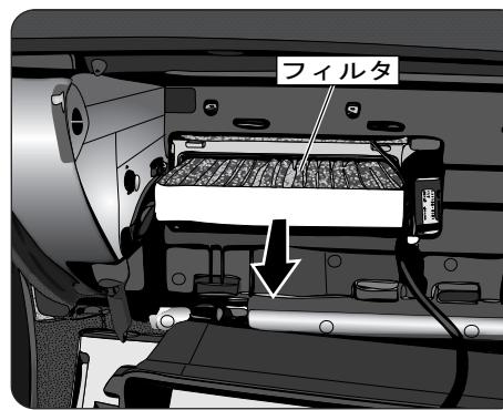
プロテクターから汚れたフィルタを取り外し、新しいフィルタを取り付けます。
