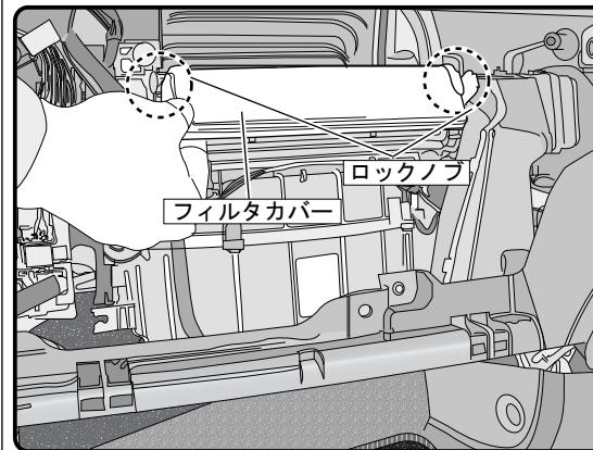
フィルタカバーの左右にあるツマミ(ロックノブ)を解除してフィルタカバーを取り外します。
