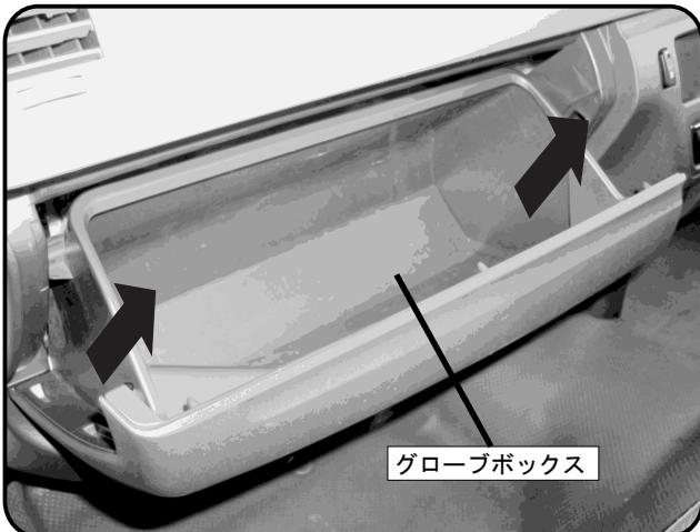
グローブボックスを開いて、矢印方向に片側ずつ引くようにしてグローブボックスを取り外します。
