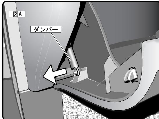
ダンパーが付いているお車はダンパーを左側に引いて、グローブボックスから外してください。(図A)
