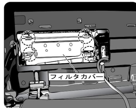
フィルタカバーのロックノブ(上下各2箇所)を解除して、フィルタカバーを取り外します。
