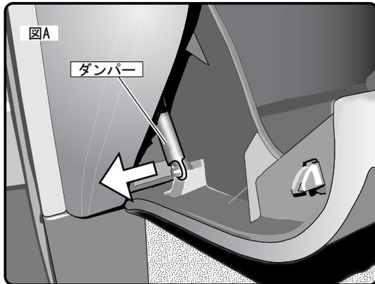
ダンパーが付いているお車はダンパーを左側に引いて、グローブボックスから外してください。(図A)
