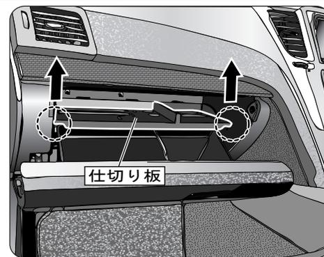
仕切り板の結合部分(左右各1箇所)を片側ずつ上へ上げて取り外します。
