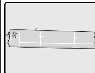
左記形状のフィルタカバーが付いていた時はフィルタの側板が手前・奥になるようにセットしてください。
