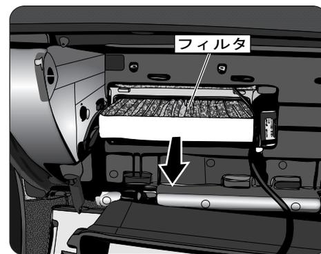
ブロアケースから汚れたフィルタを取り外し、新しいフィルタを取り付けます。
