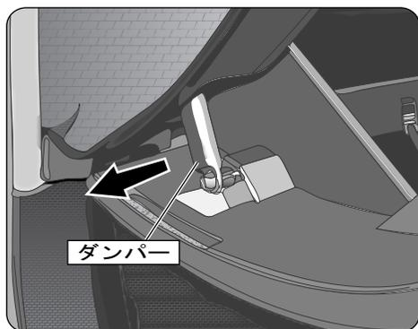
グローブボックスを開き、左側に付いているダンパーを左側にスライドしてダンパーを開放します。
