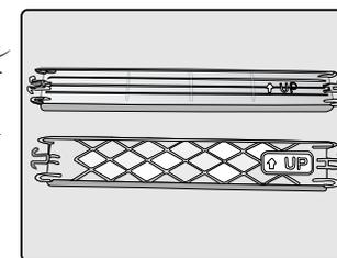
左記形状のフィルタカバーのどちらかが付いていた時はフィルタの側板が左右になるようにセットしてください。
