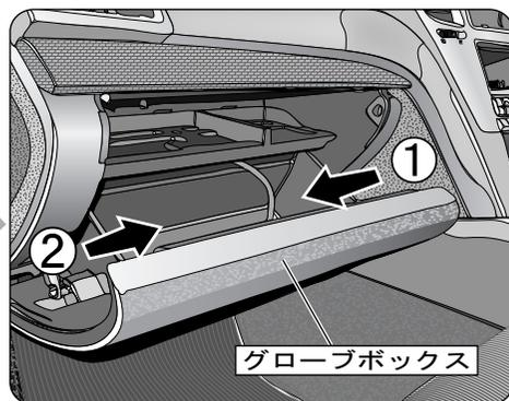
グローブボックスの両サイドを内側に押して、グローブボックス両サイドに付いているストッパーを片側ずつ(右側から)開放してグローブボックスを下に開放します。
