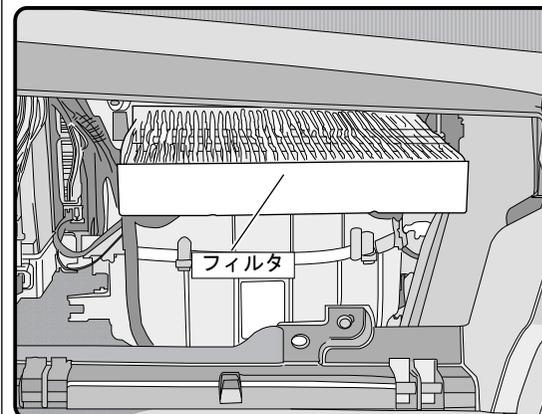
汚れたフィルタを引き出して、新しいフィルタと交換します。
