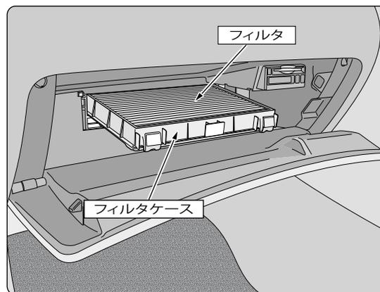
フィルタケースから汚れたフィルタを取り外し、新しいフィルタを取り付けます。フィルタの側板が左右に来るようにセットしてください。
