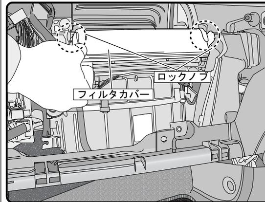
フィルタカバーの左右にあるツマミ(ロックノブ)を解除してフィルタカバーを取り外します。(お車によってはロックノブが1箇所のももあります。)
