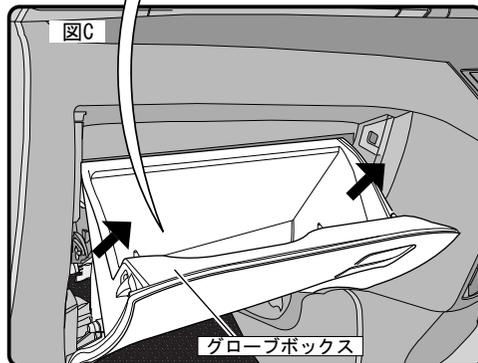
グローブボックスの両サイドを内側に押してグローブボックス左右奥(各1箇所)に付いているストッパーを解除する方法(図B)と、左右片側ずつ手前方向に引いて、グローブボックス下部に取り付いているヒンジ部分を引き抜く方法(図C)と2通りあります。図Bの方法で上手く行かない時は図Cの方法を試してみてください。
