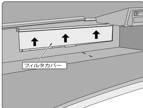
ボックス奥に取り付いているカバーを取り外します。カバー下側がツメになっていますので、矢印の方向にカバーを引き上げて取り外します。
