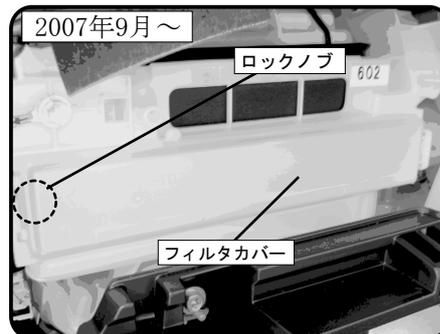
グローブボックスを外しますとフィルタカバーが見えてきますので左側のロックノブを解除してカバーを取り外します。
