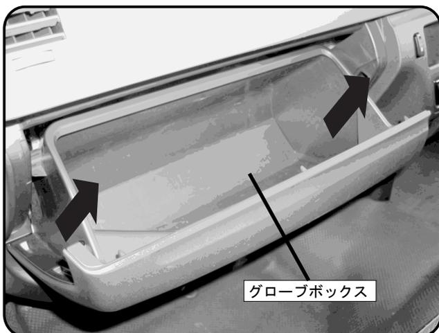
グローブボックスを開いて、矢印方向に片側ずつ引くようにしてグローブボックスを取り外します。
