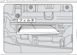
汚れたフィルタを取り外し、新しいフィルタを取り付けます。
