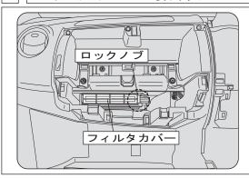
パネルを取り外した後、フィルタカバーを取り外します。フィルタカバーは右側のロックノブを解除して取り外します。
