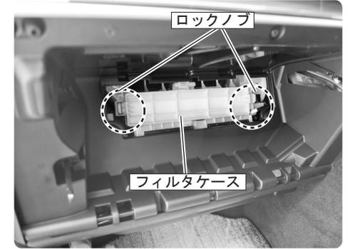
フロアケース手前のカバーのロックノブ(左右各1箇所)を解除して、カバーを取り外します。
