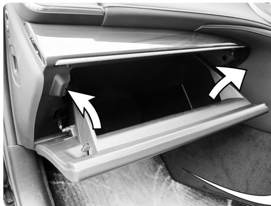
グローブボックスの左側を持って手前方向(やや上気味)に引いて、グローブボックスのヒンジ部分(グローブボックス下部分)を取り外します。
