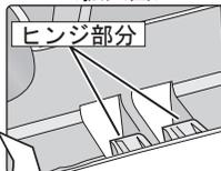
グローブボックス下部は左図のように突起状のヒンジ部分が左右に付いていてパネルに引っかかる仕組みになっています。
