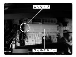
ブロアケースに付いているフィルタカバーのロックノブ(左1箇所)を解除して、フィルタカバーを取り外します。
