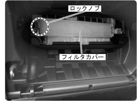
フロアケース手前のカバーのロックノブ(左右各1箇所)を解除して、カバーを取り外します。その後フィルタカバーのロックノブ(左1箇所)を解除して、フィルタケースを手前に引き出します。
