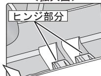
グローブボックス下部は左図のように突起状のヒンジ部分が左右に付いていてパネルに引っかかる仕組みになっています。
