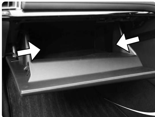
グローブボックスの左側を右側に押すとグローブボックス上部のストッパーが外れます。右側も同様に行くと、グローブボックスの上部が外れます。それからグローブボックス全体を手前方向に引いて、グローブボックスのヒンジ部分(グローブボックス下部分)を取り外します。
