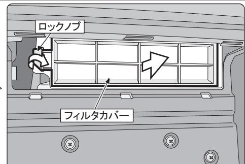
ロックノブを解除し、フィルタカバーを取り外します。
