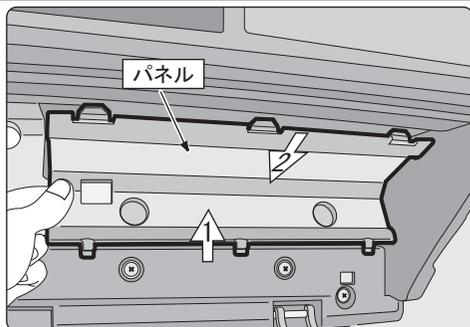
パネルを押し上げて下部についているツメ(3箇所)を解除し(矢印1)、それからパネル全体を軽く奥に押し、上部のツメ(3箇所)を解除します。(矢印2) ツメが全て解除されたらパネルを取り外します。
