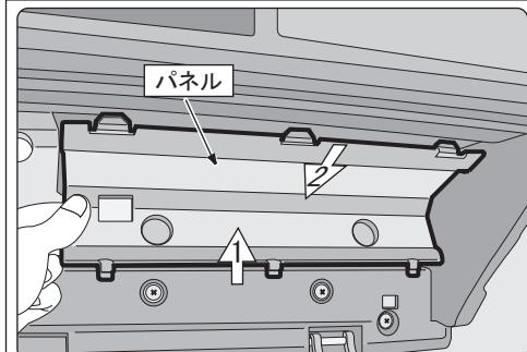
パネルを押し上げて下部についているツメ(3箇所)を解除し(矢印1)、それからパネル全体を軽く奥に押して上部のツメ(3箇所)を解除します。(矢印2)
