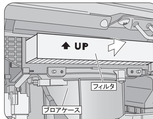
プロアケースから汚れたフィルタを取り外し、新しいフィルタを取り付けます。
