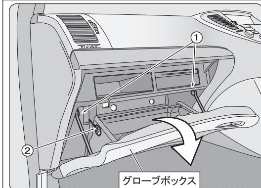
グローブボックスを開き、グローブボックスを支えているグローブボックスストップ①②をそれぞれ外し、グローブボックスを下まで開きます。
