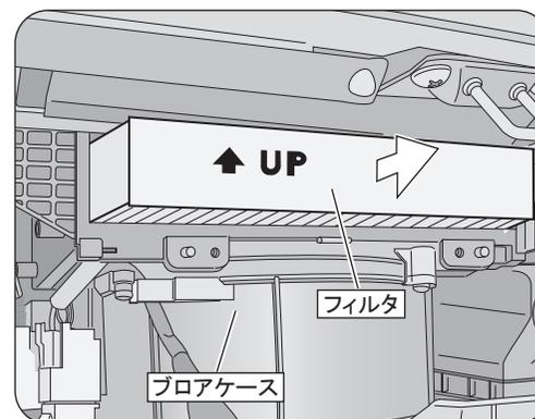
フロアケースから汚れたフィルタを取り外し、新しいフィルタを取り付けます。フィルタの側板が手前・奥に位置するようにセットしてください。
