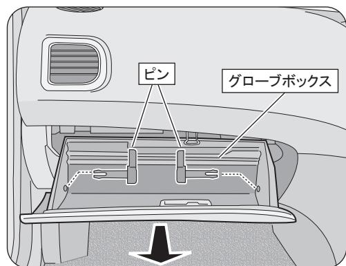
グローブボックス内側または外側に付いているピン(左右各1箇所)を外し、グローブボックスを外します。
