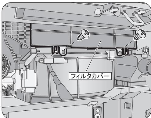
ネジ(2箇所 お車によってはネジが付いていない車種もあります)を外した後、フィルタカバーを取り外します。
