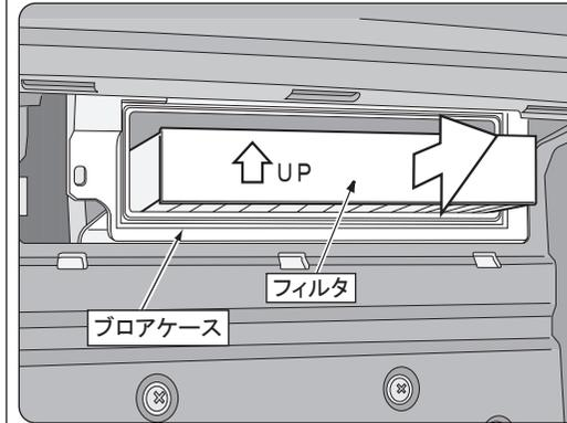
ブローケースから汚れたフィルタを取り外し、新しいフィルタを取り付けます。
