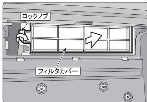
ロックノブを解除し、フィルタカバーを取り外します。
