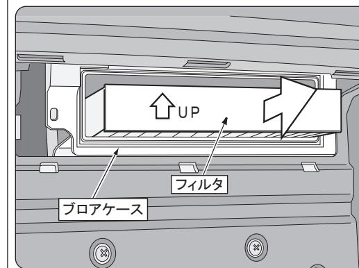
プロアケースから汚れたフィルタを取り外し、新しいフィルタを取り付けます。
