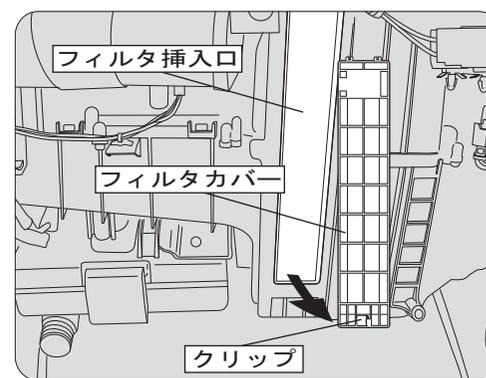
フィルタカバー下部に取り付いているクリップを外し、フィルタカバーを取り外します。
