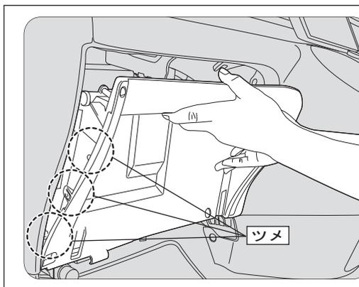
ツメ(6箇所 右3箇所 左3箇所)を外し、グローブボックス全体を外します。
