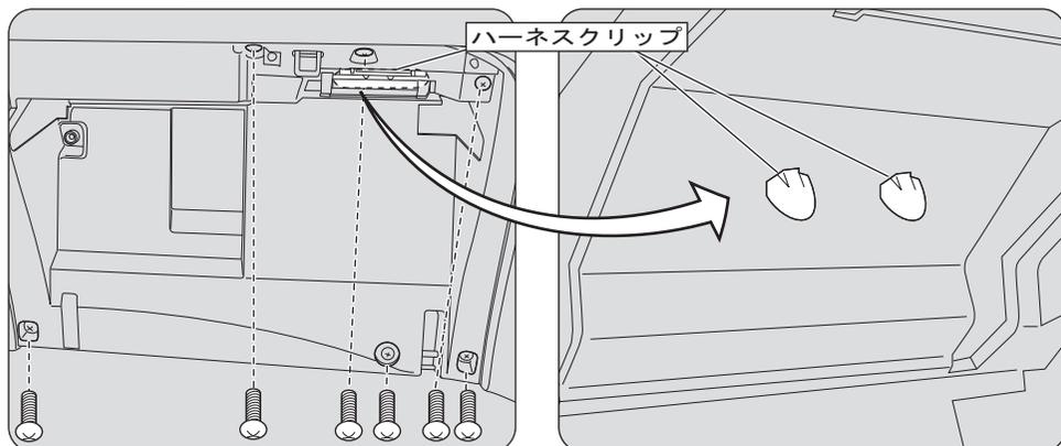
ネジ(6箇所)及び、ハーネスクリップ(右図)を取り外します。
