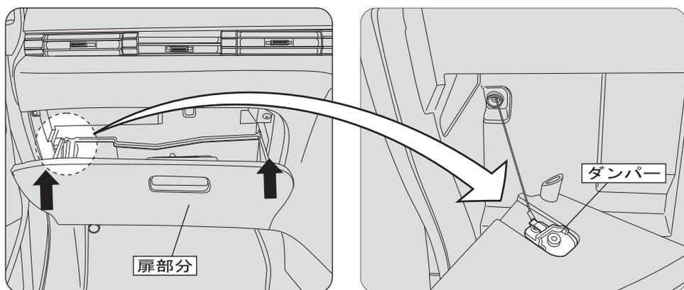
グローブボックスを開き、グローブボックス扉の両サイドを片側ずつ引き上げて、グローブボックスの扉部分を取り外します。次に、左サイドに付いているダンパー(右図)を取り外します。
