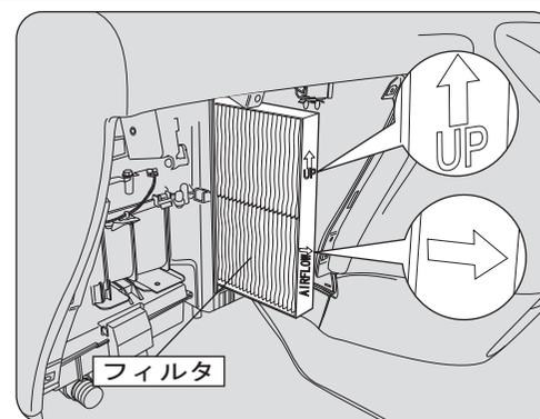
汚れたフィルタを取り外し、新しいフィルタと交換します。
