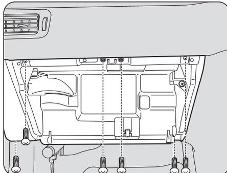
ネジ(6箇所)を外しグローブボックス及びパネルを手前に引いて外します。(上図はネジ位置を確認する為に予めグローブボックスを外しています。)
