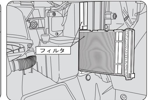
新しいフィルタと交換します。上下で二つありますのでフィルタの上下のかみ合わせ位置をあらかじめ確認しておくことで作業がスムーズに進みます。
