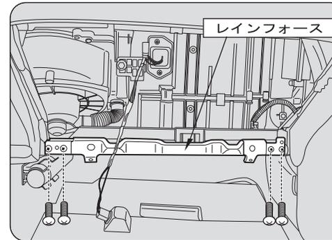
ネジ(4箇所)を外して、レインフォースを取り外します。
