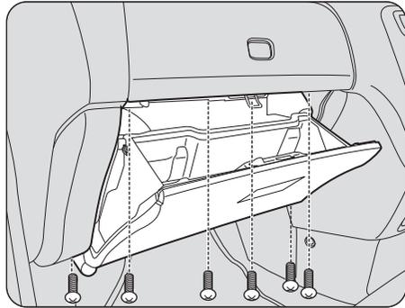
グローブボックスを開いてネジ(6箇所)を外し、グローブボックス及びパネルを手前に引いて外します。
