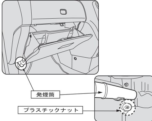
発煙筒の下の部分に付いている黒色のプラスチックナットを回して外し、発煙筒が付いているサイドパネルを外します。<左下図 解説参照>
