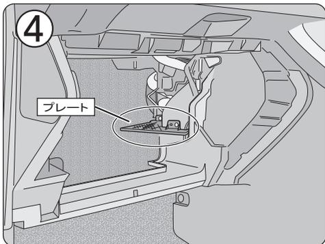
④ グローブボックスを外した状態です。○の部分は次の行程で取り外します。
