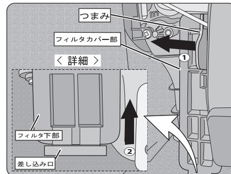
フィルタのカバー部を外します。詳細図(フィルタカバー部の下部)のように下側は差し込み口になっておりますので、カバー部の上部のつまみを引き出した後(①)、上に押し上げて外します(②)。
