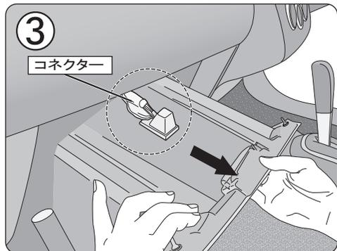
③ グローブボックス全体を手前に引き外します。その際、コネクタが取り付けられている車種はコネクタの先端を左に4分の1回転させグローブボックスから取り外します。
