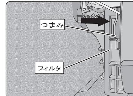
② フィルタ上部のつまみを持って奥に押し込んでください。カチッと音がすれば正しく取り付けられています。
