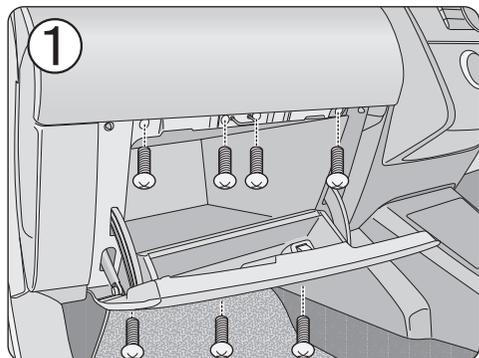
① グローブボックスを開き、ネジ7箇所(上側4箇所、下側3箇所)を外します。
