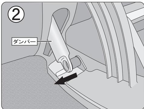
② ダンパーが取り付けられている車種は、ダンパーを左側に引いてグローブボックスから外します。
