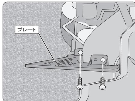
グローブボックスを取り外した後、右側奥に付いているハニカム状のプレート(ネジ2箇所)を取り外します。
