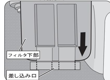
① フィルタ挿入口の差し込み口にフィルタ下部の突起をしっかりと差し込みます。
