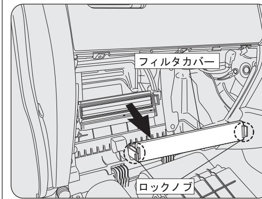
フィルタカバーの左右にあるロックノブを解除してフィルタカバーを取り外します。
