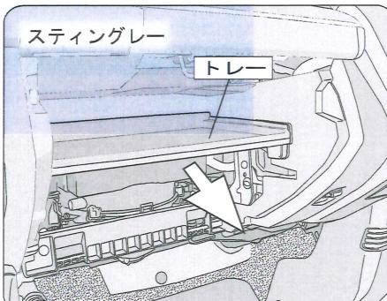
ワゴンRの場合はグローブボックスを外した後で上部のインパネトレー(ネジ2箇所)を外します。ネジ(2箇所)は上図丸印部分の裏側にあります。トレーは矢印方向に押して外してください。
