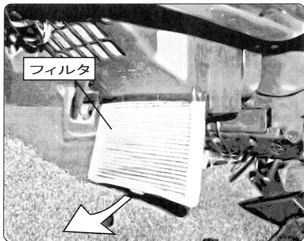
貼り付けたライニングが手前・奥になるようにセットしてください。また、フィルタに記載されているAIR FLOWの矢印が運転席側に向くようにセットしてください。
