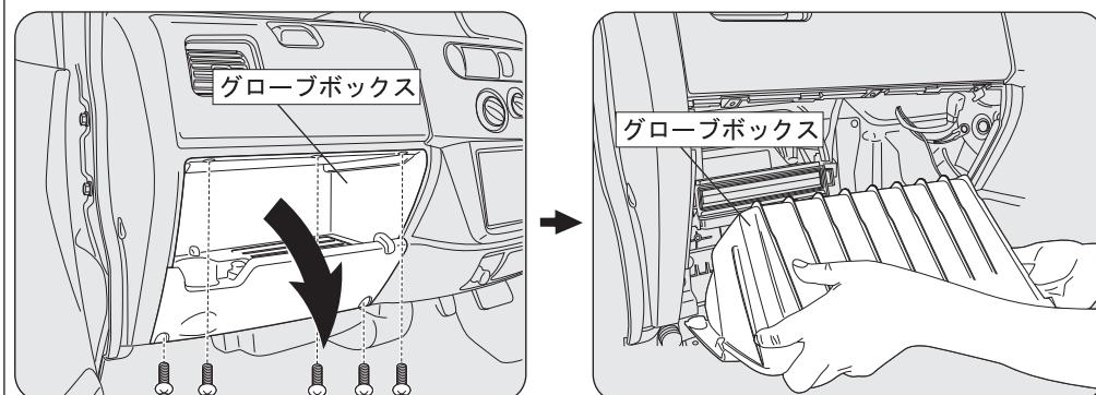
グローブボックスに付いているネジ(5箇所)を外し、グローブボックス全体を手前に引いてグローブボックスを外します。
