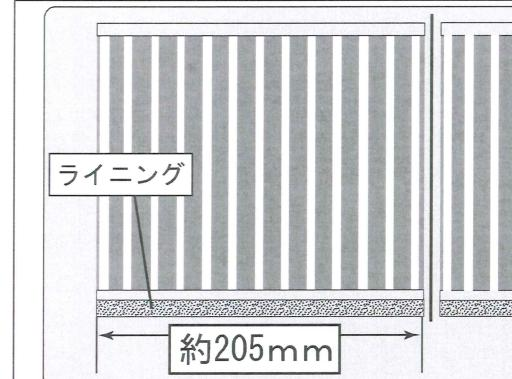
フィルタの長い辺の片方に付属のライニング(スポンジ状のシート)を貼り付けます。
