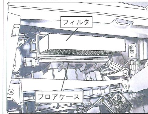
汚れたフィルタを取り出して、新しいフィルタと交換します。フィルタの側板が手前・奥になるようにセットしてください。
