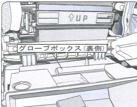
グローブボックスを開き、ボックス両側面を内側に押しながら、ボックスに付いているストッパーを片側ずつ解除した後、グローブボックスを手前に引いて取り外します。お車によってはストッパーを解除せずにグローブボックス全体を手前に引いて左右下側に付いているヒンジ部分を片側ずつ外してグローブボックスを取り外す車種(ワゴンR、ラパン等)もあります。
