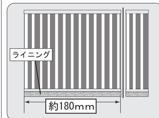
フィルタの長い辺の片方に付属のライニング(スポンジ状のシート)を貼り付けます。その後フィルタを約180mmのところ(フィルタに切れ目が入っています)でハサミ等を使って切断します。
