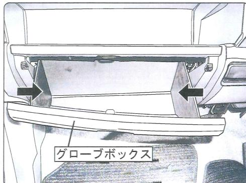
グローブボックスの左右内側を片側ずつ押して、グローブボックス両サイドに付いているストップバーを開放して、グローブボックスを取り外します。
