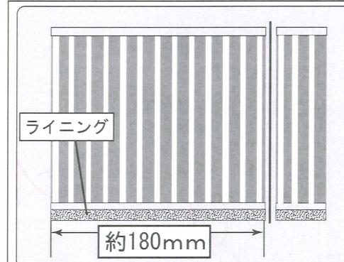
フィルタの長い辺の片方に付属のライニング(スポンジ状のシート)を貼り付けます。その後フィルタを約180mmのところ(フィルタに切れ目が入っています)でハサミ等を使って切断します。
