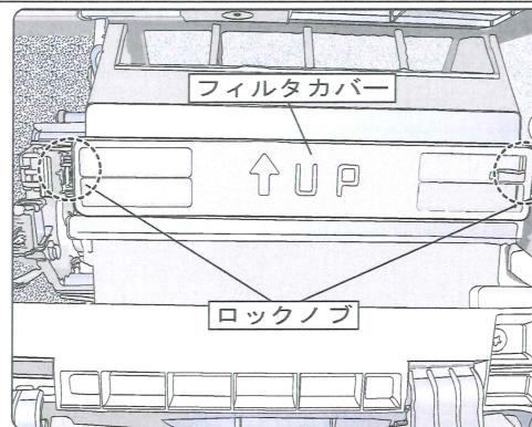
フィルタカバーの両端に付いているロックノブを解除し、フィルタカバーを取り外します。
