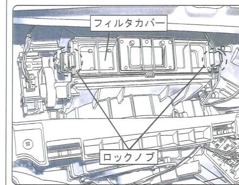
フィルタカバーの左右にあるツマミ(ロックノブ)を開放してフィルタカバーを取り外します。
