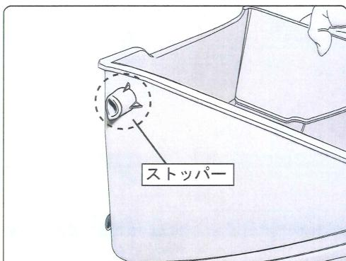
グローブボックスは左図のように突起状のストップバーが左右に付いていて、それぞれパネルに引っかかる仕組みになっています。この突起状のストップバーを損傷しないように、またグローブボックス下のはめ込む部分も損傷しないようにご注意ください。
