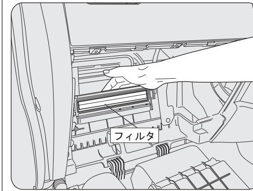
汚れたフィルタを取り出し、新しいフィルタと交換します。フィルタの側板が手前・奥になるようにセットしてください。
