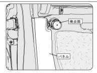
グローブボックスの下部近くにある発炎筒の付いたパネルを外します。パネルの奥に付いている蓋状のネジ(1箇所)を外した後、パネル全体を外してください。
