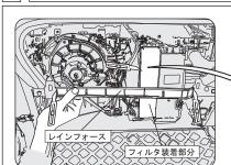
グローブボックスを外した後、未装着車はブロアケースの前に樹脂で出来た バー(レインフォース)が付いています。このレインフォースの右端と左端をカッ ター等で切り取ります。
