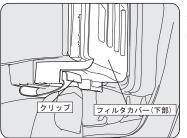
フィルタの装着が完了しましたら、フィルタカバーを装着していただき、フィルタカバー下部とブロアケースをクリップで留めます。
