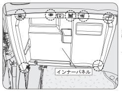
ネジ(7箇所)を外してインナーパネルを外します。
