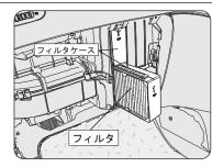
フィルタカバーが装着されているお車はフィルタカバーを取り外してからフィルタを 取り外し、付属のフィルタケースに新しいフィルタを入れて、ブロアケースに装着しま す。上下二段になっていますので、上のフィルタから先に装着してください。
