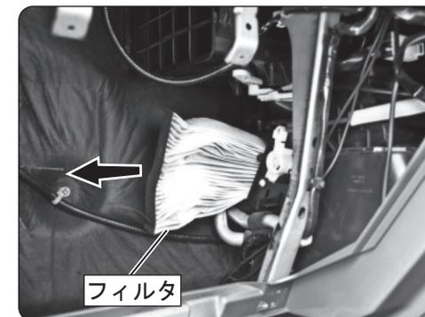
汚れたフィルタを取り外し、新しいフィルタを取り付けます。フィルタの挿入口よりもフィルタの方が大きいので、出し入れの際はフィルタを上下に掴まんでフィルタを潰しながら行ってください。
