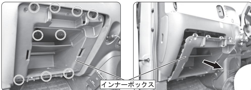
ネジ(上部4箇所 中央部2箇所 下部3箇所)を外してインナーボックスを手前に引いて外します。
