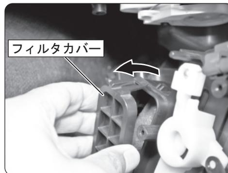
フィルタカバーの上部に付いているロックノブを手前に引いて解除し、フィルタカバーを取り外します。
