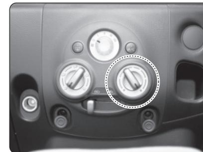
なお、フィルタカバーを取り外す際にエアコンの温度設定が低い設定になっていると、アクチエーターがカバーと干渉して外しづらくなる場合がありますので、温度設定を上げてみてください。
