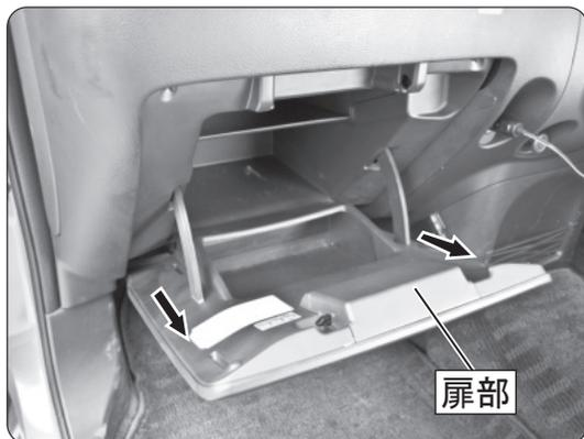
グローブボックスを開き、グローブボックスの扉部を左右片側ずつ手前に引いてボックス下部のヒンジ部を外して扉を取り外します。
