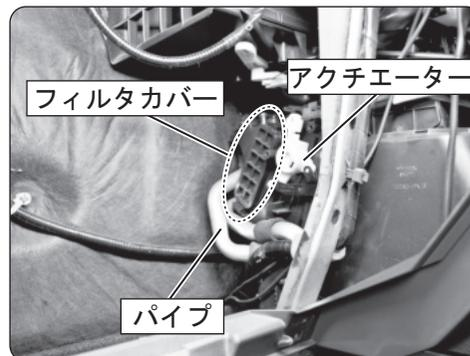
インナーボックスを取り外した後、右側奥に付いているフィルタカバーを確認します。カバーの下部のパイプはエンジンを切ったばかりですととても熱くなっておりますので、ヤケドに注意して作業してください。
