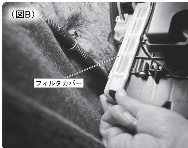
グローブボックスの下に潜り込み、グローブボックスの右奥にフィルタカバーが取り付けられていることを確認してください。(図A) ロックノブを解除し、フィルタカバーを取り外します。(図B)
