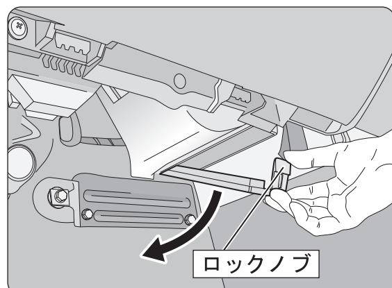
フィルタカバー手前のロックノブを解除して、フィルタカバーを取り外します。
