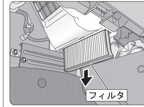
汚れたフィルタを取り外し、新しいフィルタを装着します。
