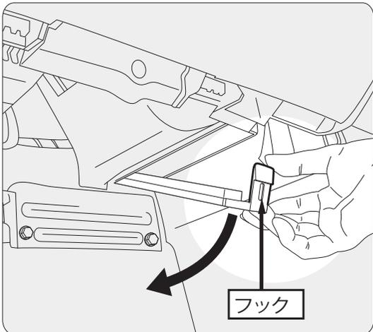
フィルタカバー手前のフックを解除し、フィルタカバーを取り外します。
