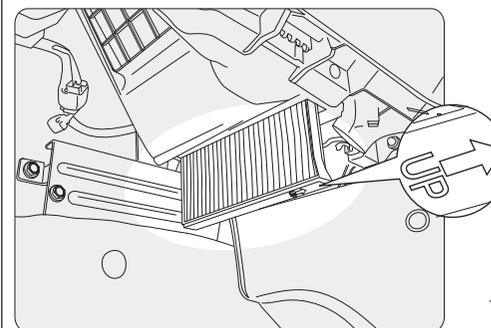
汚れたフィルタを取り外し、新しいフィルタを装着します。
