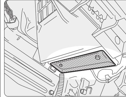
フィルタカバーが取り付けしていない時は、フィルタカバー付の23-002KCをご使用ください。その際にはフィルタ挿入部分を切り取る作業が伴います。
