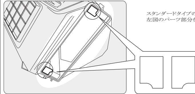
スタンダードタイプのフィルタが取り付けしていた時は、左図のパーツ部分をカットしてフィルタを取り付けます。
