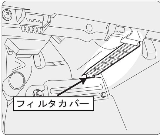
グローブボックスの下にフィルタカバーが取り付けられている事を確認します。
