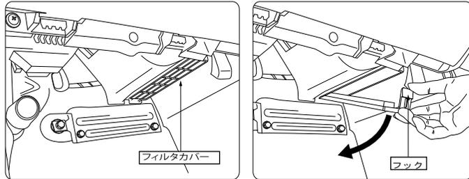
もしフィルタカバーが取り付けられている場合は、装着されていたフィルタがスタンダードタイプであれば23-002N、高機能または脱臭タイプであれば23-002Kおよび23-002Dをご使用ください。
