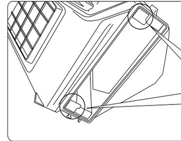
スタンダードタイプのフィルタが取り付けいていた時は左図のパーツ部分をカットしてフィルタを取り付けます。(その際にはスタンダードタイプのフィルタは取り付け出来なくなりますのでご注意ください。)
