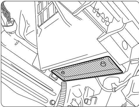
フィルタを装着する部分は、グローブボックスの下を覗き込むと見えます。フィルタ挿入口をカッター等で挿入口の溝に沿って切り取ります。
