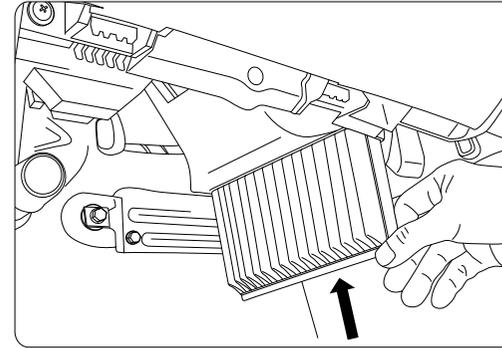
切り取った後、新しいフィルタを挿入して付属のフィルタカバーを装着します。
