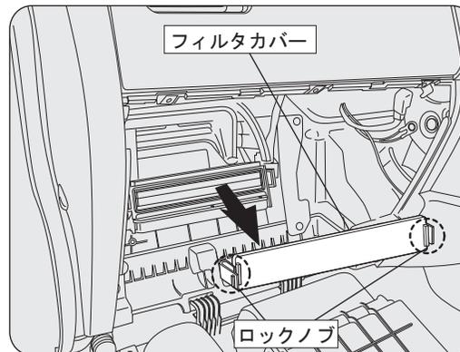
フィルタカバーの左右にあるロックノブを解除してフィルタカバーを取り外します。
