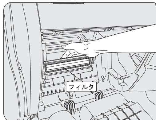
汚れたフィルタを取り出し、新しいフィルタと交換します。
