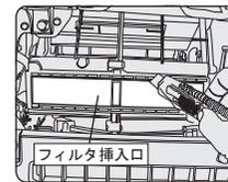
未装着車の場合、別途で必要とするものは特にございませんが、フィルタ装着部分を切り取る作業が伴います。カッター等で溝に沿って装着部分を切り取ってください。また切り取った際に、切りくずなどをブロア内に入れてしまわないよう注意して作業してください。
