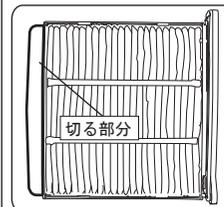
フィルタの表と裏を間違えない様にプロアケースにセットしてください。またお車がパジェロの時は年式を問わずフィルタ先端の出っ張った部分(左図太線枠内)をカッター等で切ってからフィルタを装着してください。
