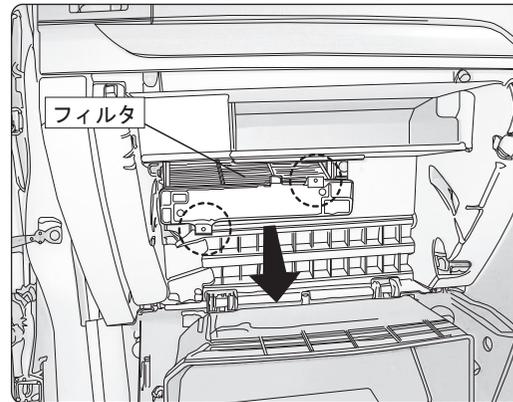
グローブボックスを外してフィルタが見えてきましたらネジ(2箇所)を外してフィルタを手前に引き出してください。
