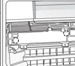
左図のように純正品にはフィルタとフィルタカバーを分離するためのネジが付いているので(左図丸印部分)その際にも当品番23-004DCを使用してください。
