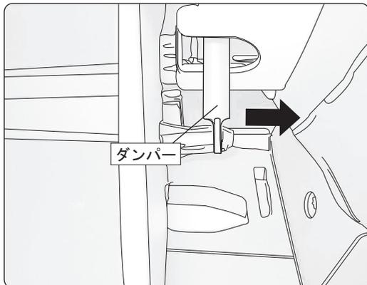
グローブボックスを開けると右側にダンパーが見えますので、右側に引いて開放します。
