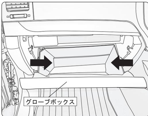
グローブボックスの両サイドを片側ずつ矢印方向に押して、グローブボックス奥に付いているストッパーを開放します。
