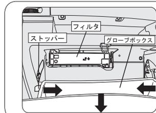
お車がグランディスの時はグローブボックスを開けると両サイドにストッパーが付いています。このストッパーは上記のように外せませんので、グローブボックスの両サイドを片側ずつ内側に押し、グローブボックスを手前に開放してください。そうしますと、フィルタが見えてきますので2)フィルタの取り外しを参考にして交換を進めてください。
