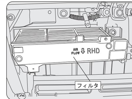
汚れたフィルタを取り出し、新しいフィルタと交換します。お車がパジェロの場合は、フィルタを装着する際にはハーネス固定用クリップも一緒に止めるようにしてください。
