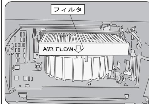
フィルタケースから汚れたフィルタを取り外し、新しいフィルタを取り付けます。フィルタの側板が手前・奥に来るようにセットしてください。
