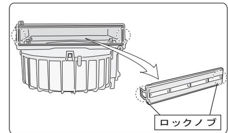
フィルタカバーの左右両端のロックノブを解除してフィルタカバーを取り外してください。
