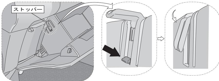
上図の黒矢印で示した部分を強く押すとストッパーが動かせる状態になります。その際、固いことがあるので十分注意してください。また、この作業はグローブボックスを全開にした状態では行えませんが、半分開じた状態で作業してください。
