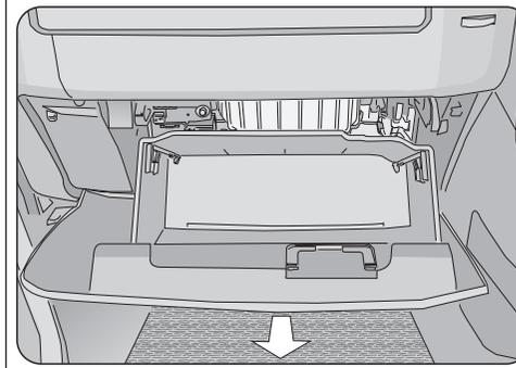
左右のストッパーを解除したら、グローブボックスを全開にして取り外します。
