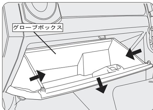
グローブボックスを開き、ボックスの両サイドを矢印方向に押し込みながら、ボックスを手前に引き出します。
