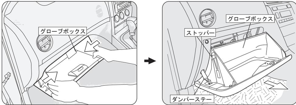
グローブボックスを開き、ボックス側面を左図のように内側に押しながら、グローブボックス両サイドに付いているストッパーを片側ずつ解除した後で、ダンパーステーをグローブボックスから開放して、グローブボックスを手前に引いて取り外します。
