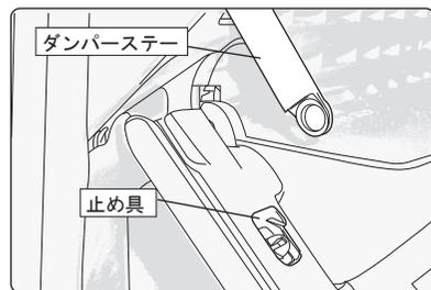
ダンパーステー先端の止め具を外して、ダンパーステーをグローブボックスから外してください。
