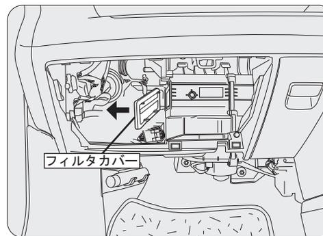
フィルタカバーを取ってフィルタを引き出します。
