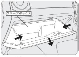
グローブボックスを開き、ボックスの両サイドを 矢印方向に押し込みながら、ボックスを手前 に引き出します。
