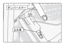
ダンパーステー先端の止め具を外して、 ダンパーステーをグローブボックスから外し てください。
