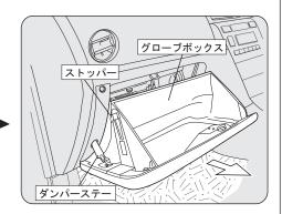
グローブボックスを開き、ボックス側面を左図のように内側に押しながら、グローブボックス 両サイドに付いているストッパーを片側ずつ解除した後で、ダンパーステーをグローブボックスから開放して、グローブボックスを手前に引いて取り外します。
