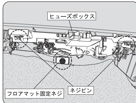
ネジ(左右各1箇所)を外します。ネジは下に開放されるだけで完全には取り外せません。
