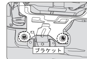
アンダーカバーの後ろに隠れているブラケットの12mmのナット(2箇所)を外して、ブラケットを外します。ソケットレンチで外す際は深めの物を使用してください。
