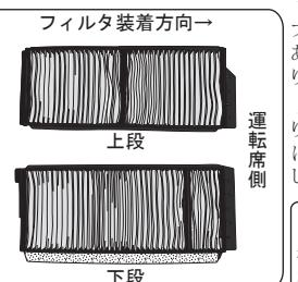
古いフィルタを取り出して、新しいフィルタと交換します。上下で二つありますので、上のフィルタから取り出します。
