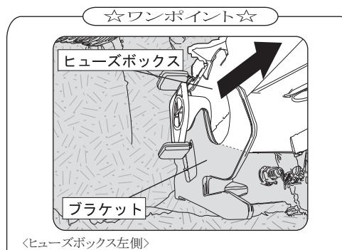
ヒューズボックスは上図のようにブラケットで左右固定されています。ヒューズボックスを手前に引いて開放してください。左右均等にヒューズボックスを前後に調整しながら外してください。
