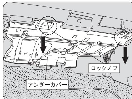
グローブボックスの下をのぞくと上図のように黒色のアンダーカバーが付いておりますので、左右のロックノブを外して下に引き、アンダーカバーを外してください。
