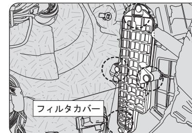
ブラケットを外した右奥にフィルタカバーが取り付いておりますので、ネジ(4箇所)を外してフィルタカバーを取り外します。
