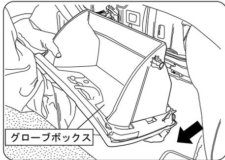
グローブボックスを開けてから、グローブボックスの右下部分を浮かすようにして、手前に引いて外します。
