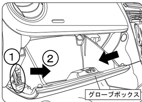
グローブボックスを開けて、左側のダンパーを開放してから(①)グローブボックスの両サイドを矢印方向に押しグローブボックスを下に開放します。(②)
