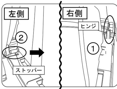
グローブボックス右側はヒンジ部分がかみ合わさるようなかたちになっていますので、それを手前に引いて外した後(①)、左側はストッパーが差し込まれているだけです。右側へ引き抜くようにしてください。(②)
