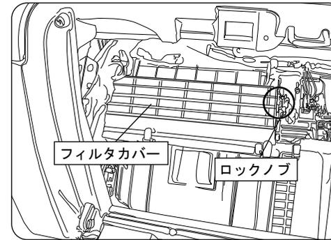
グローブボックスを外しますとフィルタカバーが左側に見えますので、右側のロックノブを解除して取り外します。一部配線が掛かっている部分がありますので、損傷しないようにご注意ください。
