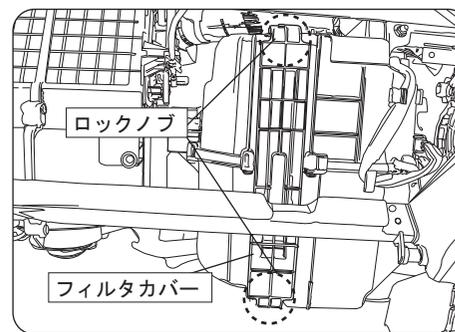
グローブボックスを外しますと、フィルタカバーが見えますので、上下のロックノブを解除してフィルタカバーを取り外します。下側から先に解除してください。
