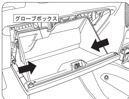
グローブボックスを開けてからグローブボックスの両サイドを矢印方向に押しボックス左右奥に付いているストッパーを開放します。
