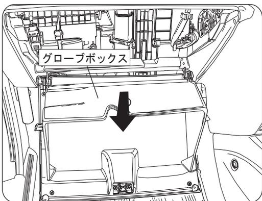
グローブボックスの下部は左右のヒンジ部分で固定されていますので上記手順でグローブボックスを開放してから手前に引くとグローブボックスを取り外す事が出来ます。
