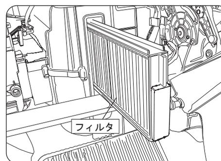
古いフィルタを取り出して、新しいフィルタと交換してください。上下で二つありますので、上段のフィルタから手前に引いて取り外してください。
