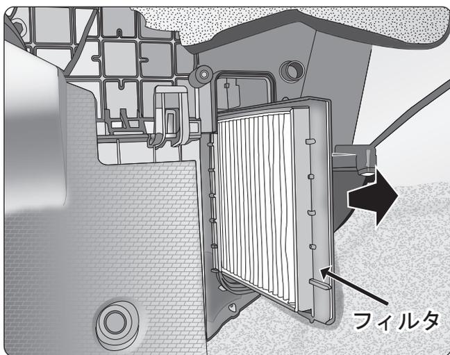
汚れたフィルタを取り外してください。上下で2個ありますので、下段から先に手前に引き出してください。
