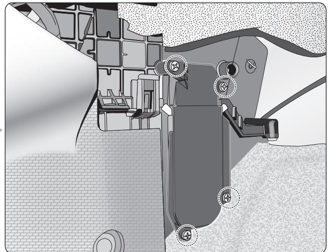
運転席の下、ブレーキペダルの左側方向にフィルタカバーがあることを確認してください。ネジ(4箇所)をドライバー等で外してフィルタカバーを取り外してください。
