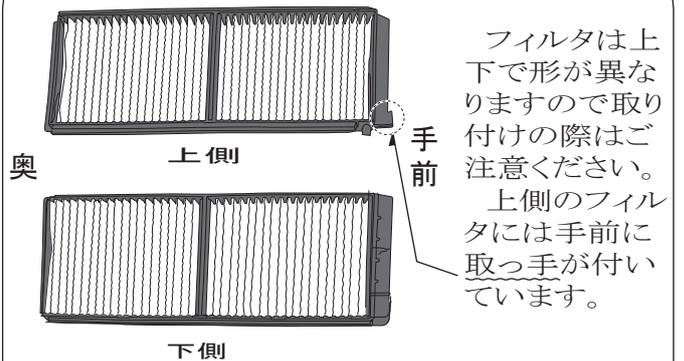
取り付けの際は上側のフィルタを先に装着し、上側フィルタの取っ手をつまんで持ち上げ、その下に下側のフィルタを装着してください。
