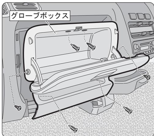
グローブボックスを開き、ネジ(左右各1箇所)及びピン(上2箇所、下2箇所)を外し、グローブボックスを取り外します。
