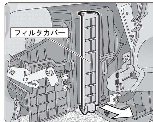
フィルタカバー下部を手前に引き上げるようにしてフィルタカバーを取り外します。
