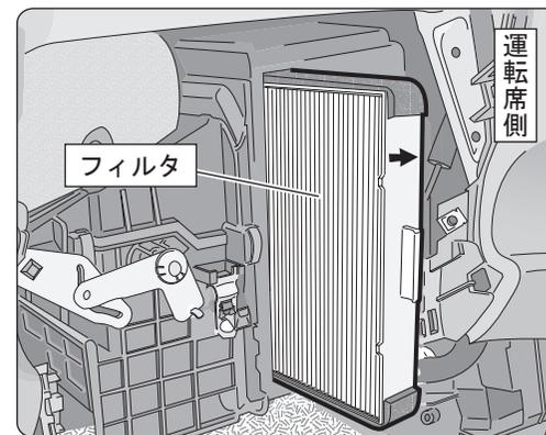
汚れたフィルタを引き出し、新しいフィルタを装着します。
