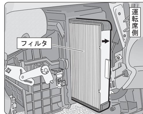
汚れたフィルタを引き出し、新しいフィルタを装着します。純正フィルタを装着していた場合、純正フィルタケースが必要無くなりますが、再度純正品を装着の際は必要となる事がありますので、保存される事をおすすめします。
