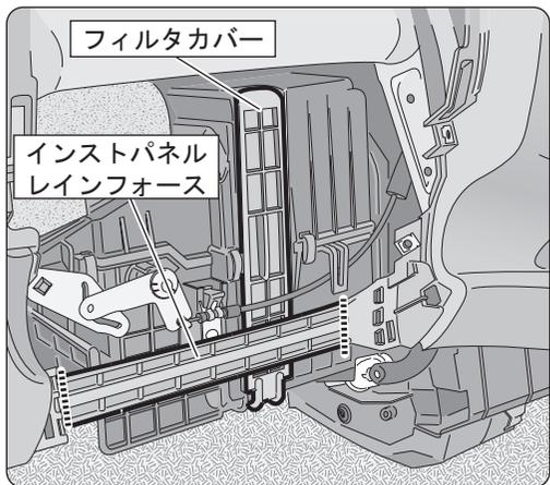
初回交換時のみインストパネルレインフォースを切り取ります。点線部をカッター等で切り取ってください。
