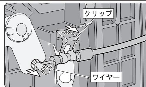
クリップを手前に引いて解除し、図のようにワイヤーを外します。
