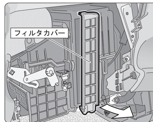
フィルタカバー下部を手前に引き上げるようにしてフィルタカバーを取り外します。
