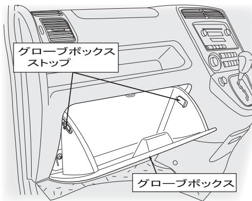
グローブボックスを開き、ボックスの両側に取り付いているグローブボックスストップを外してグローブボックスを取り外します。
