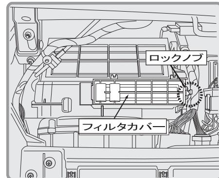
ロックノブを解除し、フィルタカバーを取り外します。
