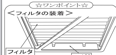
フィルタをフィルタケースに装着の際は、フィルタの末端をツメ部に確實に装着してください。
