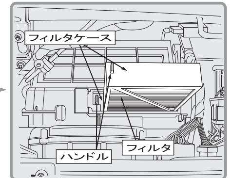
フィルタカバーを取り外した後、フィルタケースを手前に引き出します。
