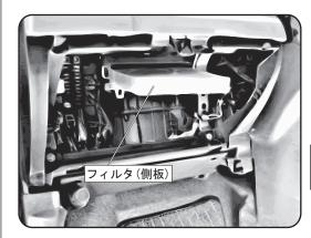
先ほどの工程で切り取った部分にフィルタを装着 してから付属のフィルタカバーで左側のロックノブ がパチッと音がするまで閉めてください。
