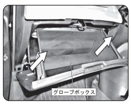
グローブボックスを矢印方向(手前方向)に片側ず つ引いてグローブボックスを取り外します。 初回交換ですと外しづらいので、ボックス下部分 のヒンジを損傷しないよう慎重な作業を心掛けてく ださい。
