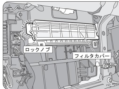
グローブボックスを取り外すとフィルタカバーが見えてきますので、左側のロックノブを解除して取り外します。
