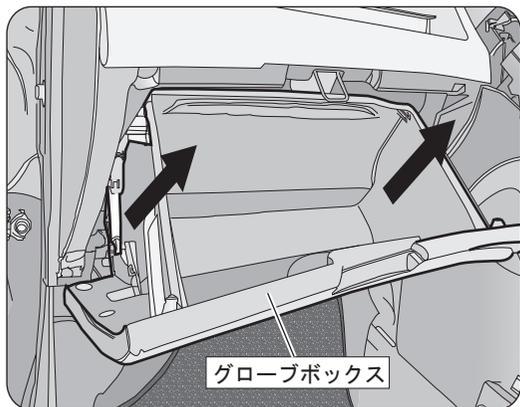
グローブボックスを片側ずつ矢印方向(手前方向)に引いてグローブボックスを取り外します。
