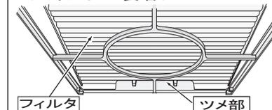
フィルタをフィルタケースに装着する際は、フィルタの末端をツメ部に確実に装着してください。
