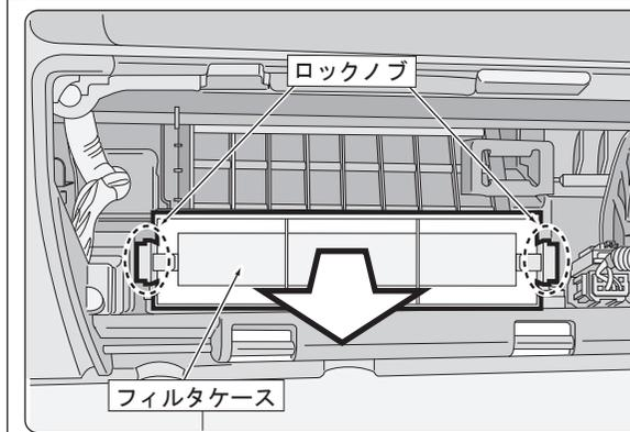
ロックノブを解除し、フィルタケースを手前に引き出して取り外します。
