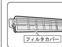
フィルタカバーの取り付けしていない未装着車の場合、別途でフィルタカバー(純正番号 88892-B2020)が必要となります。
