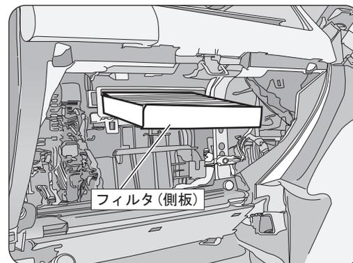
汚れたフィルタを取り出し、新しいフィルタと交換します。
