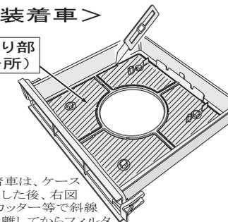
未装着車は、ケースを取り出した後、右図の様にカッター等で斜線部を切り離してからフィルタをセットしてください。
