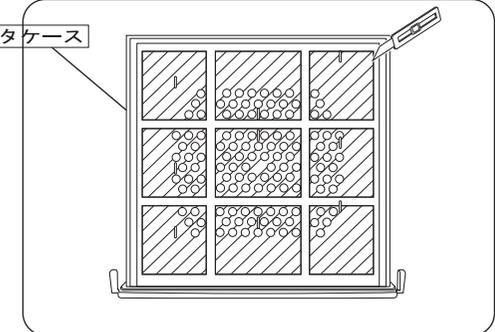
フィルタケースから汚れたフィルタを取り外し、新しいフィルタを取り付けます。フィルタの側板がフィルタケースの左右に位置するようにして装着してください。
