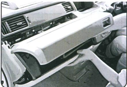
初回交換の時など、グローブボックスが引っ掛かりやすくなっておりますので損傷しないように慎重に作業を進めてください。
