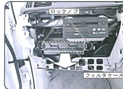
点線枠内がフィルタケースになっておりますので、両側のロックノブを解除してフィルタケースを手前に引き出してください。
