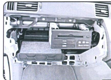
フィルタケースから汚れたフィルタを取り外し、新しいフィルタを取り付けます。フィルタの側板の向きが左右に位置するようにフィルタケースにセットしてください。
