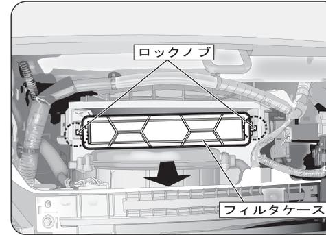
フィルタケースの両端に付いているロックノブ(左右各1箇所)を外し、フィルタケースを取り出します。
