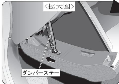
グローブボックス左側にあるダンパーステー(1箇所)を矢印の方向にスライドして開放します。上記工程でストッパーが開放出来ない時はこちらの工程を先に行なってみてください。(ダンパーステーが付いていない車種もあります)
