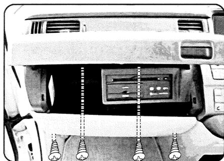
グローブボックスを開けてネジ(4箇所)を取り外します。
