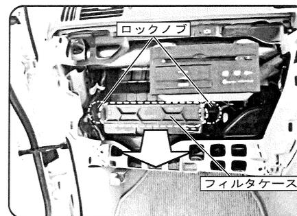
点線枠内がフィルタケースになっておりますので、両側のロックノブを解除してフィルタケースを手前に引き出してください。
