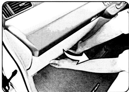
グローブボックスの下側を持って手前に引くようにしてグローブボックス全体を取り外します。
