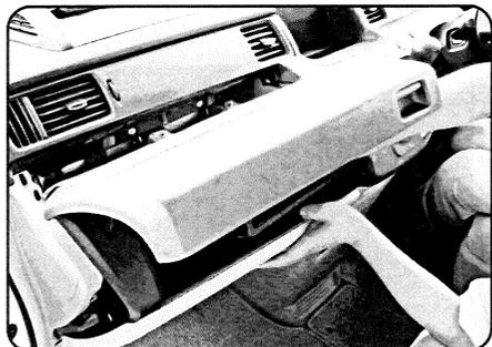
初回交換の時など、グローブボックスが引っかかりやすくなっておりますので損傷しないように慎重に作業を進めてください。
