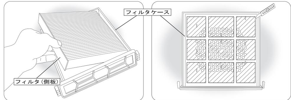
フィルタケースから汚れたフィルタを取り外し、新しいフィルタを取り付けます。フィルタの側板がフィルタケースの左右に位置するように装着してください。
