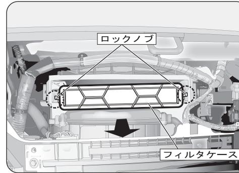
フィルタケースの両端に付いているロックノブ(左右各1箇所)を外し、フィルタケースを取り出します。
