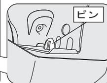
左図はボックスの左下を下からのぞいた図です。ピンが付いているので先にラジオペンチ等で外してください。
