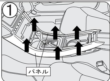
センターコンソール左右に付いている木目調のパネルを引き上げるようにして取り外します。パネルを損傷しないように慎重に作業を進めてください。
