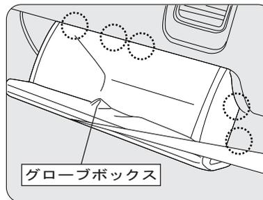
グローブボックスを開けて、ネジ(上3箇所、右側2箇所)を外します。グローブボックスの左下にピンが付いているので、そこを先に抜いてからグローブボックス全体を外してください。
