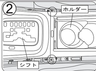
シフト手前に付いているネジ(2箇所)を外します。ジュースホルダー側のネジを外してください。
