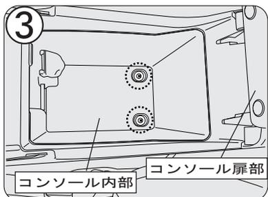
ロアコンソールを開けて、ロアコンソールに付いているネジ(2箇所)を外します。
