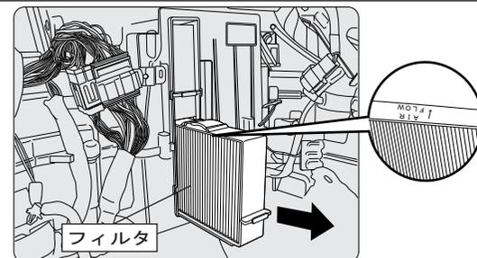
古いフィルタを取り出して、新しいフィルタと交換してください。フィルタ側部に明示されているAIR FLOWの隣の矢印が運転席側に向くようにフィルタをセットしてください。
