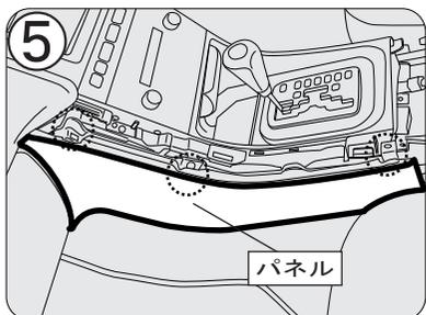
ネジ(3箇所)を外して太線のパネルを外します。ロアコンソール側から外すようにしてください。
