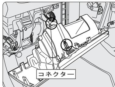
グローブボックスライトが付いているお車はグローブボックスを外している時に外すようにしてください。コネクターが固くなって取り外しづらい場合がありますので、慎重な作業を心掛けてください。
