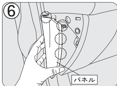
グローブボックス左側に付いているヒューズボックスパネルを外します。(ツメ4箇所)
