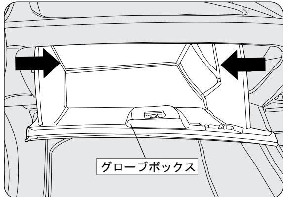
グローブボックスを開けてから、矢印方向にグローブボックスの奥にあるストッパー(左右各1箇所)を押しながら手前に引いて、グローブボックスのストッパーを開放します。
