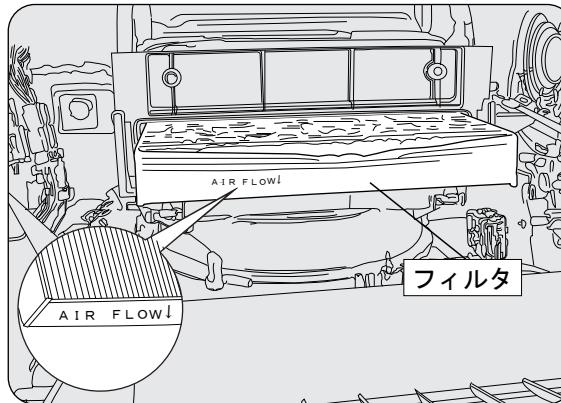
汚れたフィルタを取り出して、新しいフィルタと交換してください。
