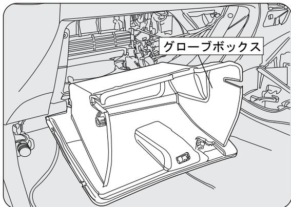
グローブボックスは外さなくてもフィルタの交換は可能です。グローブボックスを下に開放すると奥にフィルタカバーが見えます。
