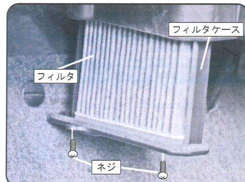
もともと取り付いていたネジでフィルタケースを取り付けて作業完了です。
