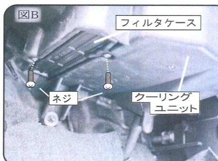
グローブボックスの下に潜り込み(図A)、クリーリングユニットの左側にフィルタケースが取り付いていることを確認して取り外します。(ネジ2箇所 図B)
