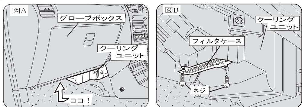
グローブボックスの下に潜り込み(図A)、クーリングユニットの左側にフィルタケースが取り付けられていることを確認して取り外します。(ネジ2箇所 図B)
