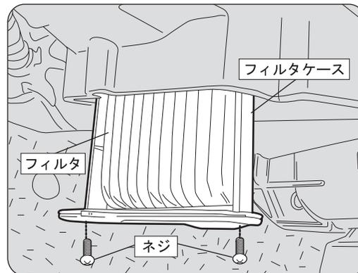
もともと取り付けいていたネジでフィルタケースを取り付けて作業完了です。
