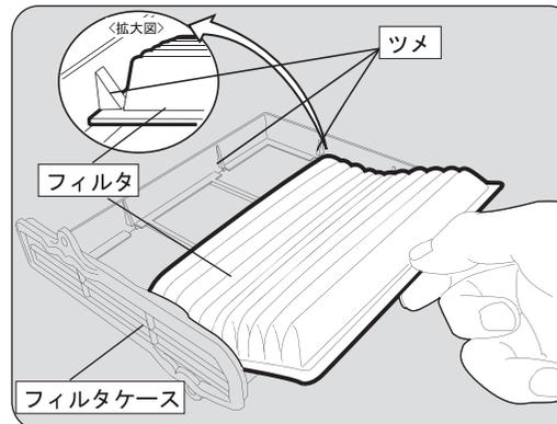
フィルタケースから古いフィルタを取り外して、新しいフィルタを装着します。
