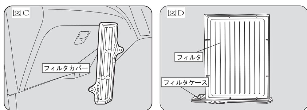
フィルタケースを外して図Cのようにカバーのみの形状だった時は27-001N(F-601)だけでは取り付けられませんので、フィルタケース付属の27-001NC(F-601C)を使用してください。図Dのようにケース状でしたら、次の工程に進んでください。
