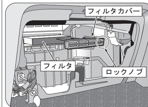
グローブボックスを外しますとフィルタカバーが見えて来ますので、右側のロックノブを解除してカバーを取り外し、フィルタを交換してください。
