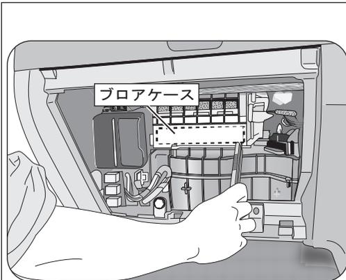
グローブボックスを外した後、ブロアケースの [ ] 部分にフィルタカバーが取り付けしていない時は、27-002Wでは交換出来ませんのでフィルタカバー付属の27-002DCを使用してください。
