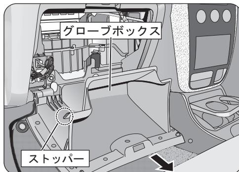
グローブボックスを開き、ボックス側面を左図の様に押し込みながら、ボックス左右奥に取り付いているストッパーを片側ずつ外した後、グローブボックスを手前に引いて取り外します。
