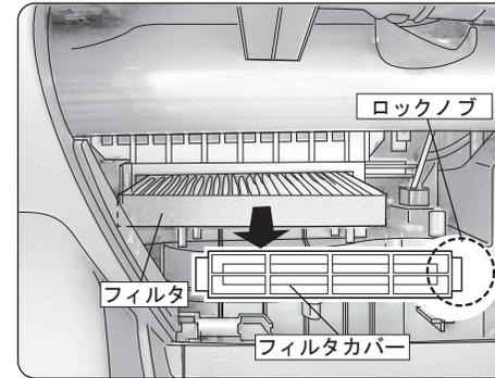
グローブボックスを外しますとフィルタカバーが見えて来ますので、右側のロックノブを解除してカバーを取り外し、フィルタを交換してください。
