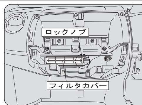
パネルを取り外した後、フィルタカバーを取り外します。
