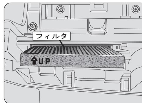
汚れたフィルタを取り外し、新しいフィルタを取り付けます。
