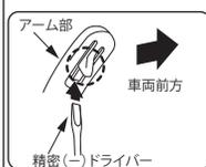
アーム部分の先端は、左図の丸印部分の様に突起状になっております。アーム部分が外しづらい場合は精密ドライバー等で突起部分を押しさえながら手前に引くと、外しやすくなります。
