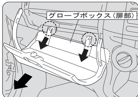
両側のアーム部分を引き抜いた後、丸印のヒンジ部分を手前に引いて外し、グローブボックス扉部を取り外します。
