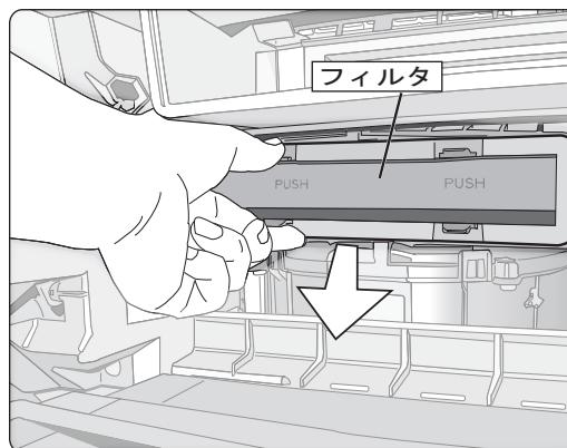
フィルタの両端に付いているロックノブを外し、手前にフィルタを引き出します。
