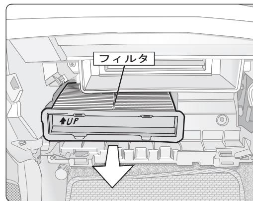
汚れたフィルタを取り外し、新しいフィルタを取り付けます。
