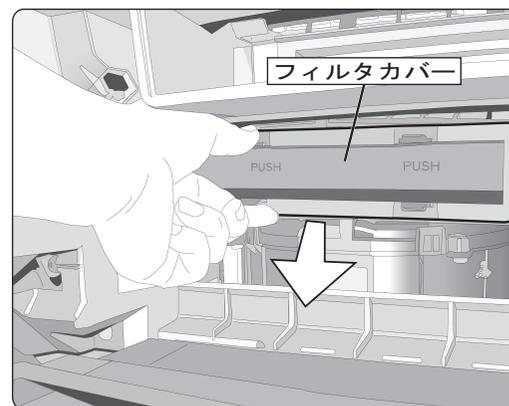
フィルタカバーの両端に付いているロックノブを外し、手前にフィルタを引き出します。
