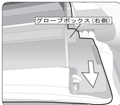
グローブボックスを開いた状態で、奥の部分をつかみながら手前に引いて、グローブボックスのヒンジ部分を左右片側ずつ外します。グローブボックスの開き角度によっては外しづらい事がありますので、ヒンジ部分の損傷にご注意ください。
