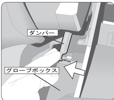
グローブボックスを開き、グローブボックスの左側に付いているダンパーを左側に引いて、グローブボックスから取り外します。
